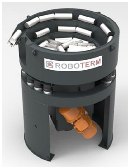
Abb. 1 - Wendelförderer für die automatische Zuführung von Knüppeln in Schmiedelinien
